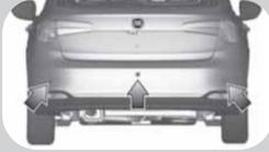
Cette voiture est équipée d'une aide au stationnement **arrière**. Les capteurs **détectent l'espace** entre l'obstacle et la voiture et **émettent un signal sonore** de plus en plus rapide si **l'espace diminue**.
